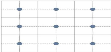
图 8 中型教室测量点的选择框图
